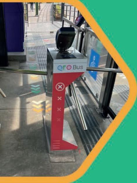
Es un **dispositivo giratorio** que facilita el control para el ingreso y la salida de las y los usuarios en las estaciones del transporte público.
